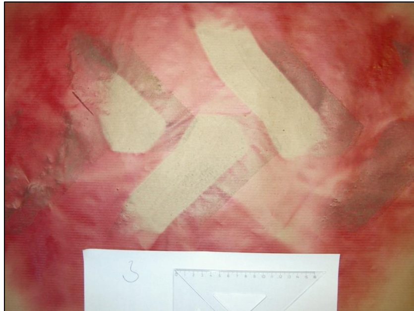
Obr. 1: Měření styčné plochy pneumatik (Zemánek 2015)
