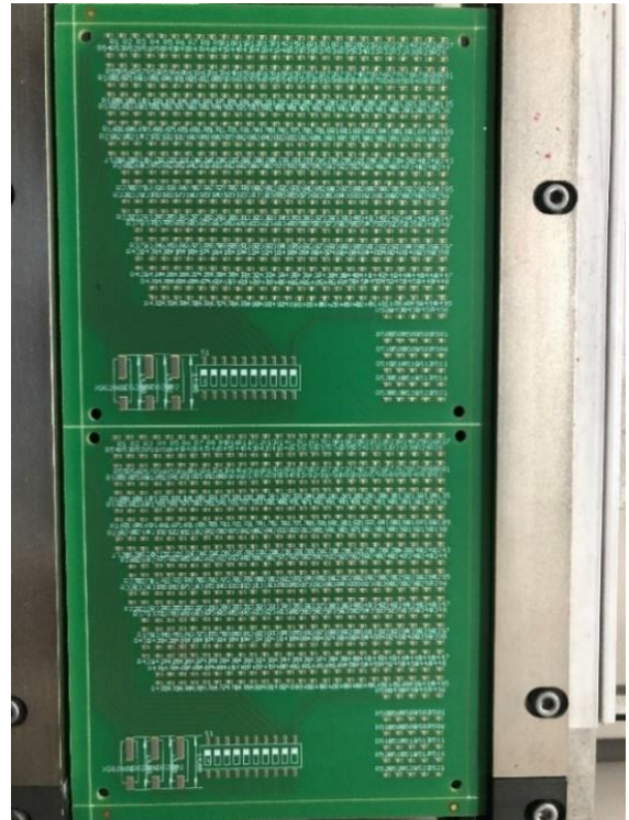
Obrázek 9: Vyhotovená DPS a nanesení pájecí pasty
