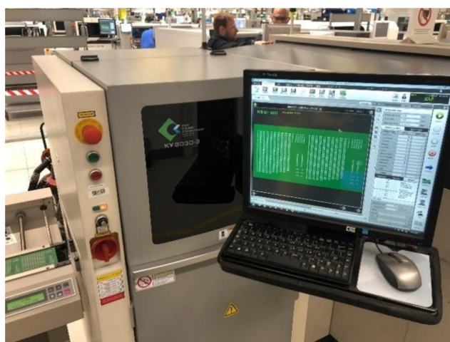
Obrázek 10: Hodnoty pro nanesení pájecí pasty a kontrola nanesení pájecí pasty
