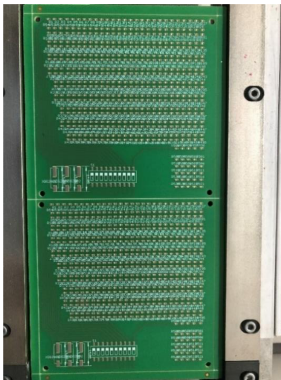
Obrázek 9: Vyhotovená DPS a nanesení pájecí pasty
