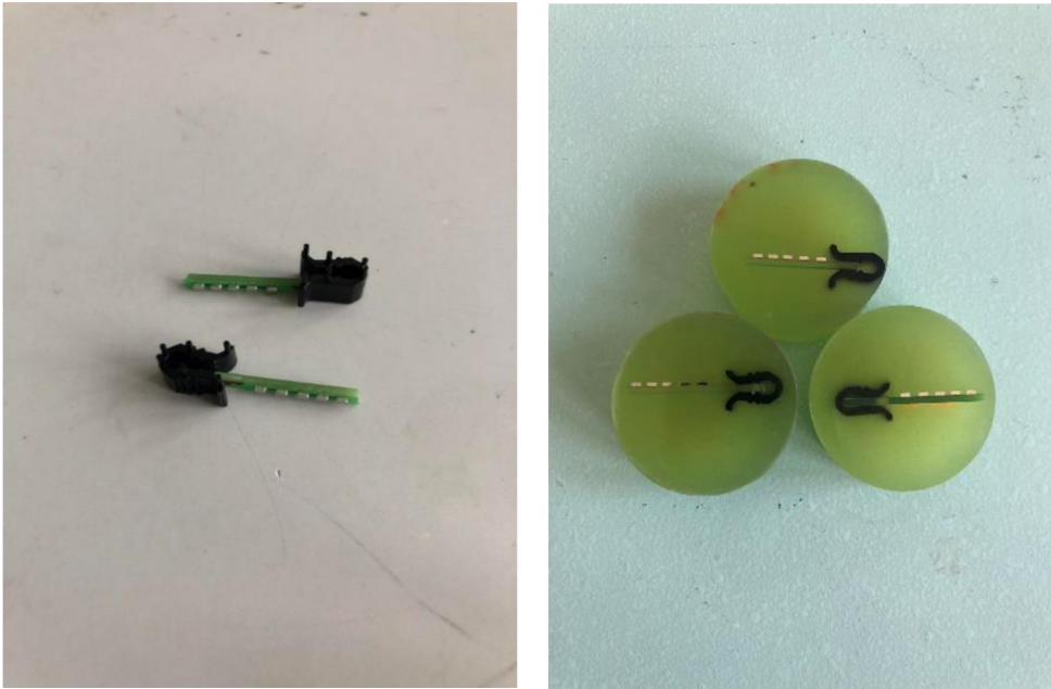
Obrázek 27: Vlevo vzorky připravené pro zalití směsí a vpravo vzorky připravené na pozorování
