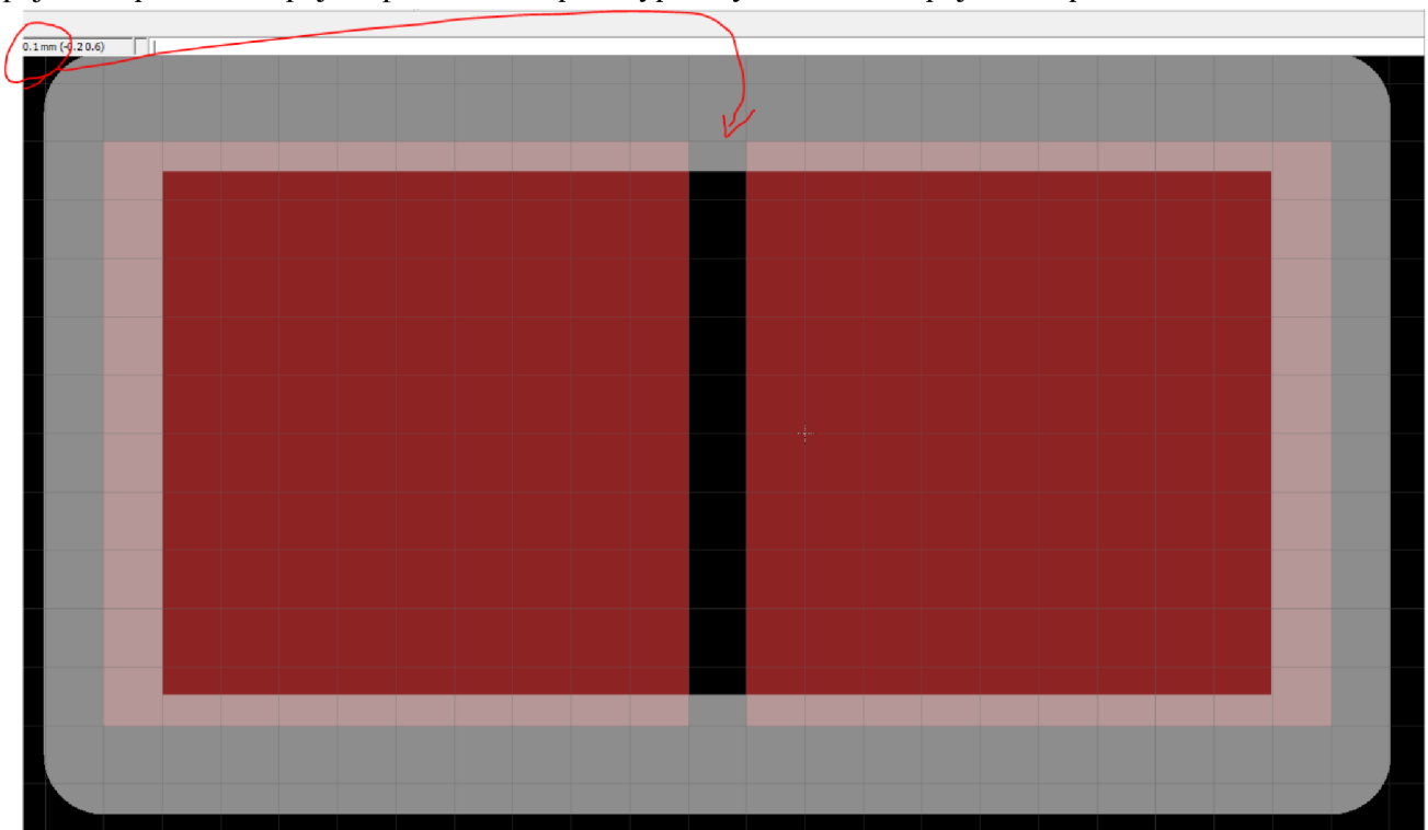
Obrázek 8: Detail mezery mezi pady 0,1 mm
