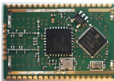
Obrázek 3.3 Pohled na odkryté RN2483 [35]
