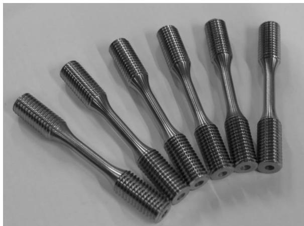
Obr. 26: Dokončené zkušební tyče pro zkoušku tahem
