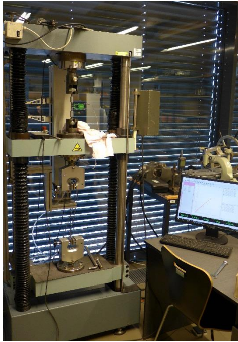
Obr. 7: Univerzální trhací stroj TIRA
