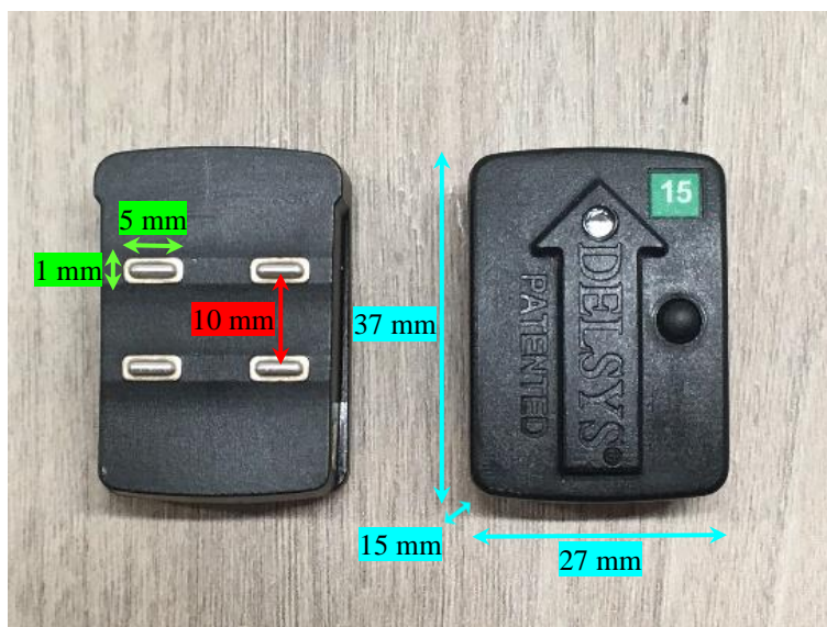
Obrázek 4. Bezdrátový sensor Trigno TM (Delsys Inc., Natick, MA, USA) se dvěma diferenciálními a dvěma referenčními elektrodami (archiv autora)
