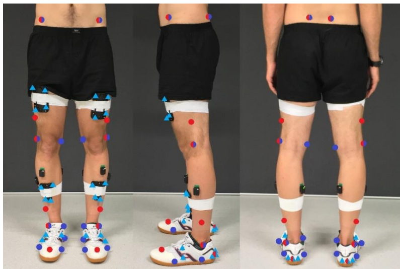
Obrázek 3. Modely „Plug-in Gait“ (červená) a „six degrees of freedom (6DoF)“ (odstíně modré) pro dolní polovinu těla. Trojúhelníkové značky odpovídají sledovacím markerům 6DoF modelu, půlené znázorňují markery patřící do obou modelů (archiv autora).
