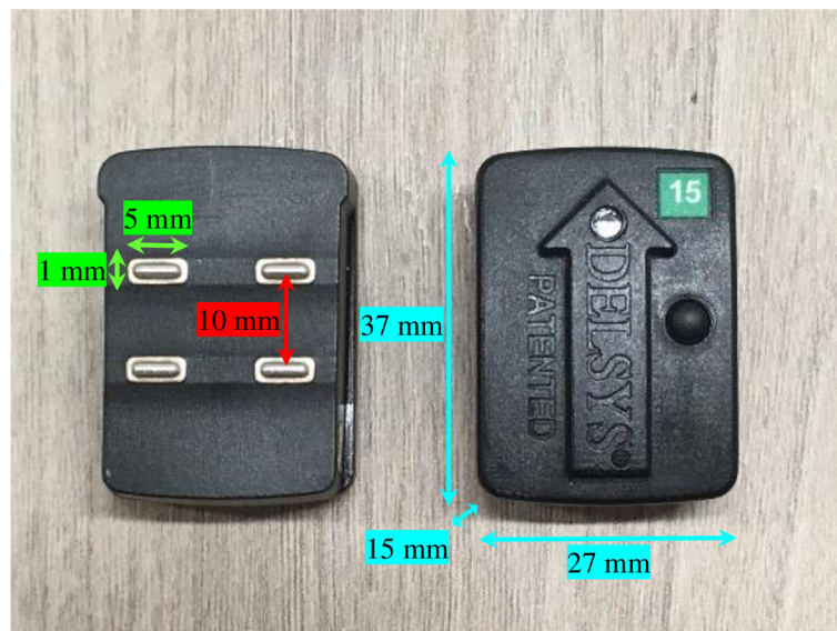
Obrázek 4. Bezdrátový senzor Trigno™ (Delsys Inc., Natick, MA, USA) se dvěma diferenciálními a dvěma referenčními elektrodami (archiv autora)
