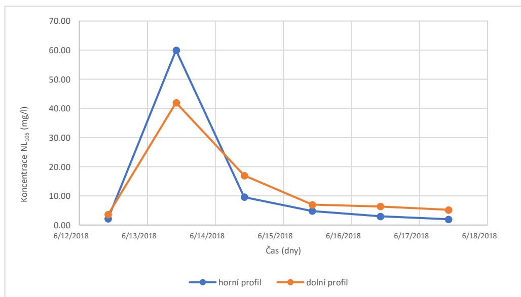
Obr. 6: Koncentrace NL_{105} (mg/l) v povrchových vodách horního a dolního profilu Bedřichovského potoka v průběhu srážkové epizody od 12. 6. 2018 do 17. 6. 2018
