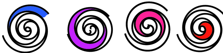
Obr. 1.7.4 Průběh stlačení vzduchu spirálami kompresoru [43]
