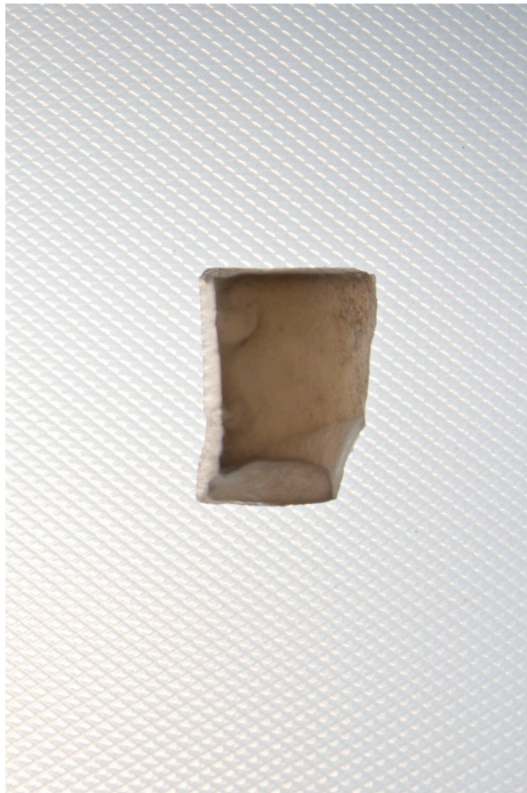
Obr. 54. Vzorek 3/70 po HIPování fotografovaný průchozím světlem
