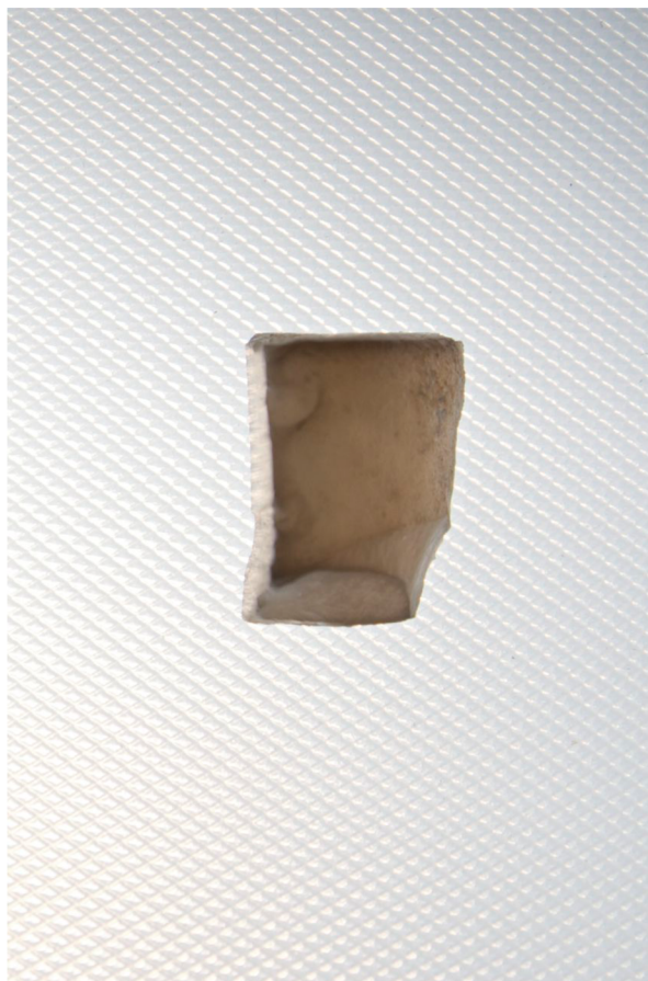
Obr. 54. Vzorek 3/70 po HIPování fotografovaný průchozím světlem
