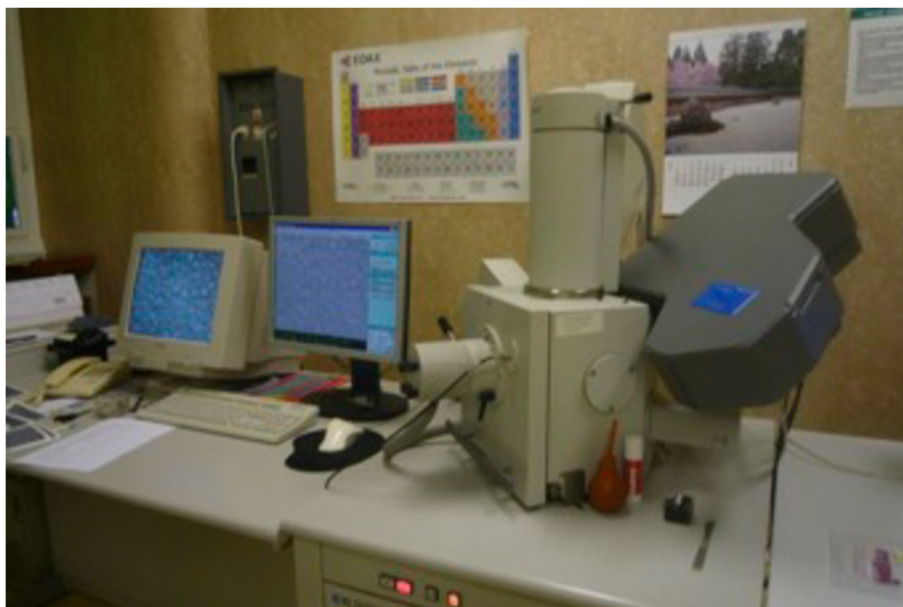
Obr. 27. Elektronový skenovací mikroskop Philips XL30
