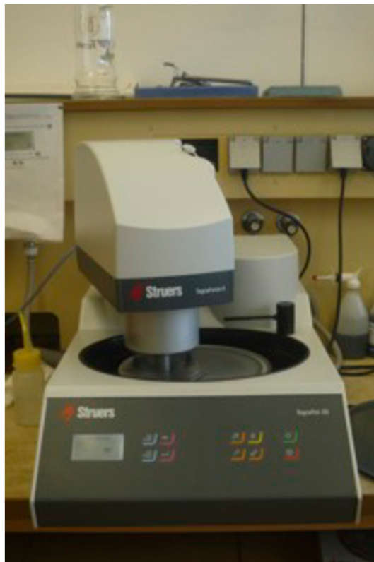
Obr. 25. Struers TegraPol – 25 s hlavou Struers TegraForce – 5
