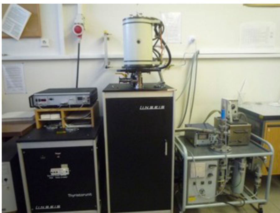
Obr. 19. Vysokoteplotní dilatometr L70/1700
