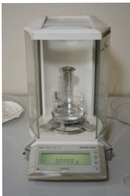
Obr. 21. Laboratorní váhy Mettler Toledo AG64
