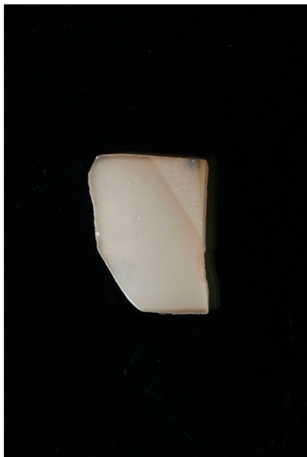
Obr. 55. Vzorek 3/70 po HIPování a vyleštění fotografovaný odraženým světlem
