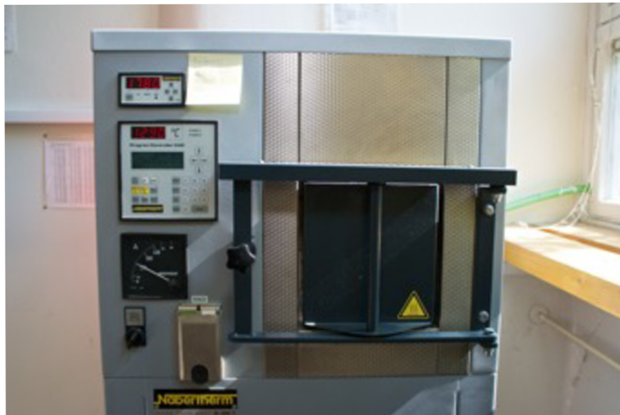
Obr. 20. Odporová pec Nabertherm HT 08/17
