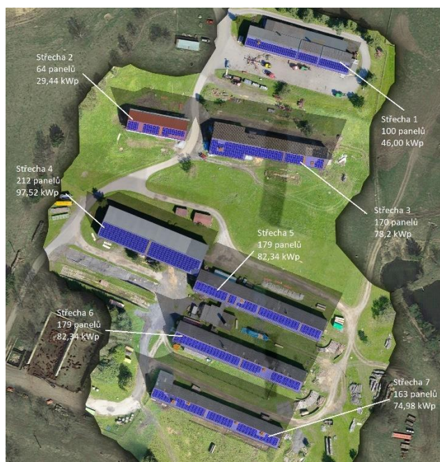
Obrázek 14 Design na základě kapacity a orientace střech
