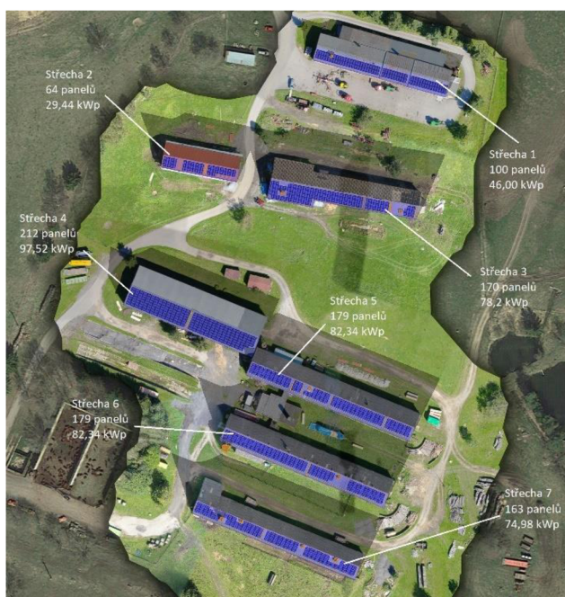
Obrázek 14 Design na základě kapacity a orientace střech
