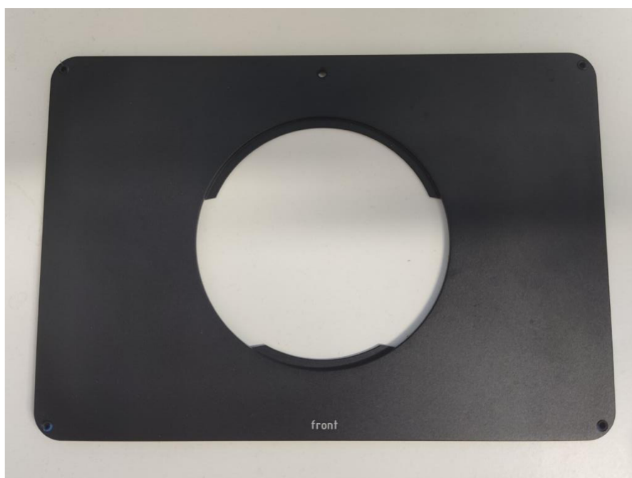
Obrázek 3 – Vyjímatelná vložka polohovacího stolku pro světelný mikroskop ZEISS
