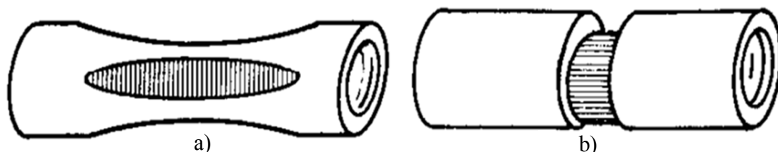
Obrázek 2 - a) Opotřebení od kolize trubka-trubka nebo trubka-plášť, b) Opotřebení od kolize trubka-přepážka [11]
