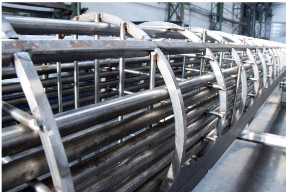
Obrázek 29 - Příklad tyčových přepážek [50]
