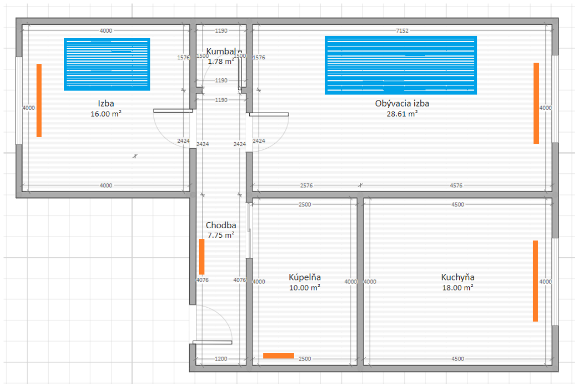
Obr. 7.1: Dispozičné rozloženie budovy pre testovacie účely
