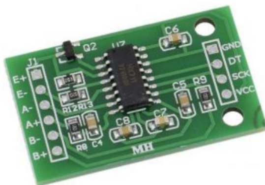
Obrázek 13: AD převodník HX711 [14]
