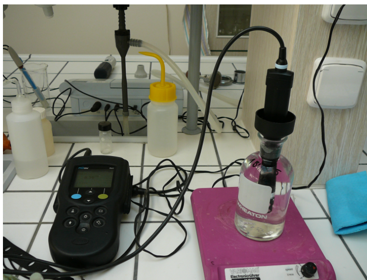
Obrázek 15 - Zařízení na měření BSK (přenosný multimetr HQ40d)
