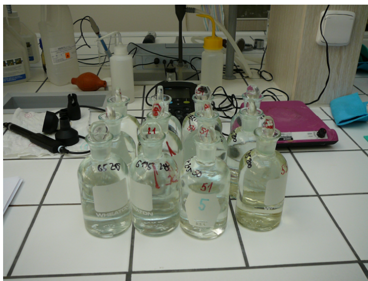
Obrázek 14 - Inkubační lahve se zabroušenými skleněnými zátkami
