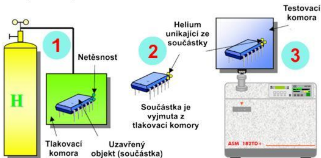
Obrázek 15: Měření těsných výrobků bombingovým testem [1]
