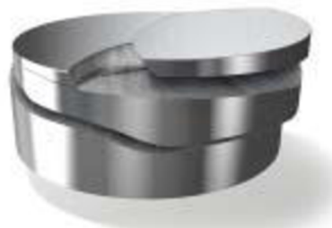
Obr. 15 Pokročilé stádium vyštipování nástroje [16]
