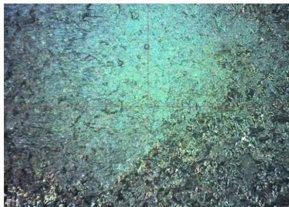
Obr. 81 Povrch nástroje po 6000 ks při 20x zvětšení
