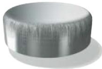
Obr. 5 Opotřebení hrany nástroje [16]
