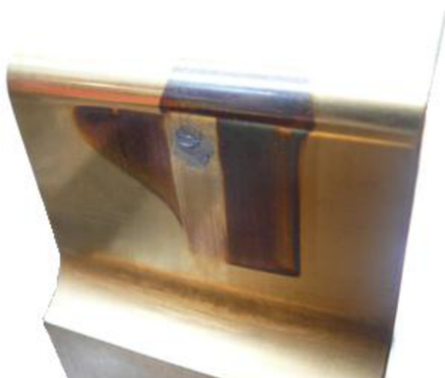
Obr. 11 Poškozená ohybová plocha
