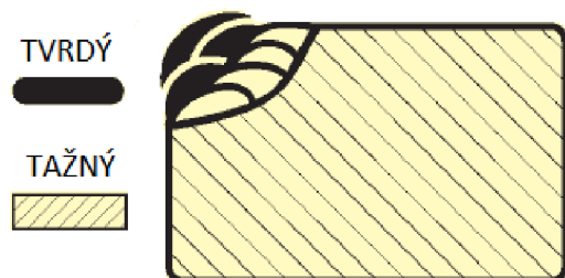
Obr. 34 Struktura návarů s mezivrstvou [12]
