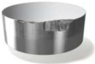
Obr. 14 Odlupování části nástroje [16]
