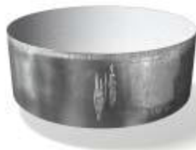
Obr. 9 Adhezivně opotřeбенý nástroj [16]
