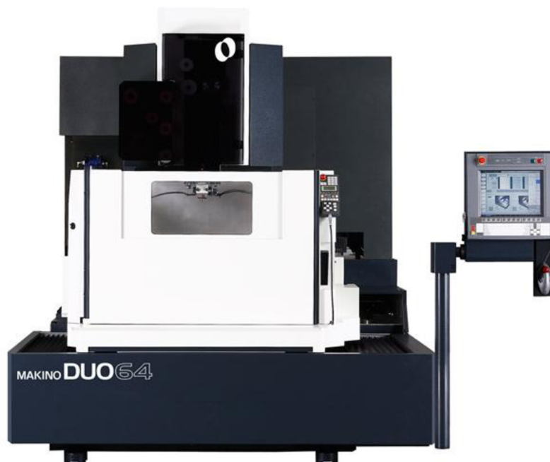
Obr. č. 9: Stroj na drátové obrábění společnosti Makino (21)
