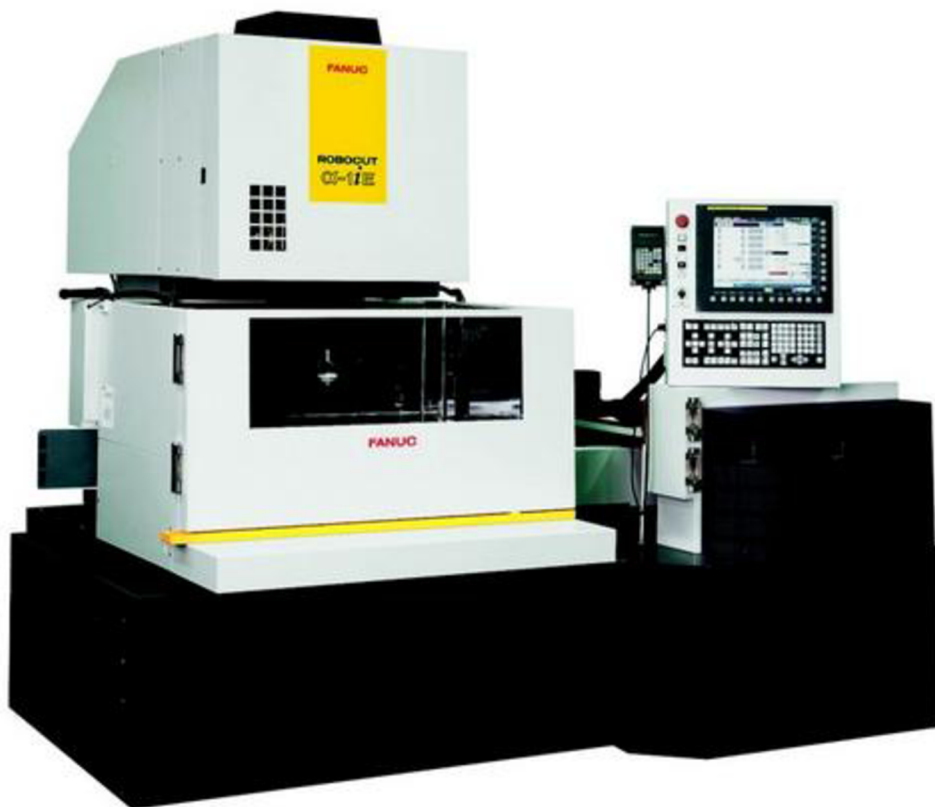
Obr. č. 8: Drátová řezačka společnosti FANUC (17)
