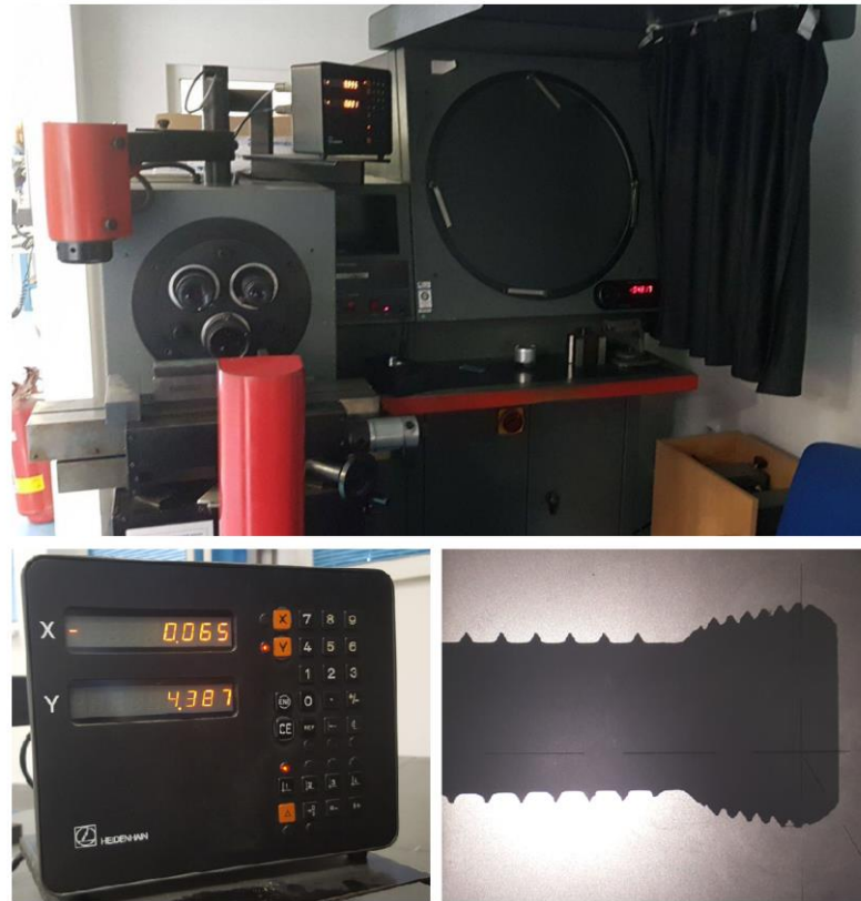
Obrázok 10.8: Profilprojektore LM 10-ATLAAS od talianskeho výrobcu MICROTECHNIKA sri
