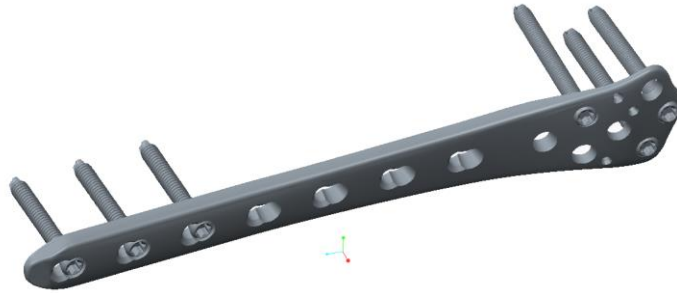
Obrázok 10.10: Geometrická konfigurácia s označením X6, využité otvory pre skrutky D, E, G, a 5,6,7( legenda označenia otvorov vid' orb.6.17)
