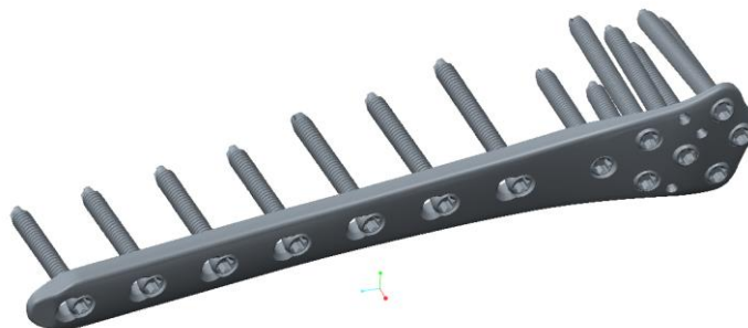
Obrázok 10.12: Geometrická konfigurácia s označením X14, využité sú všetky otvory pre skrutky
