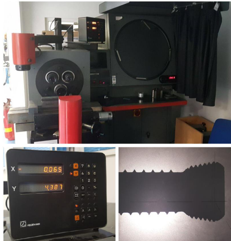
Obrázok 10.8: Profilprojektore LM 10-ATLAAS od talianskeho výrobcu MICROTECHNIKA s.r.l.
