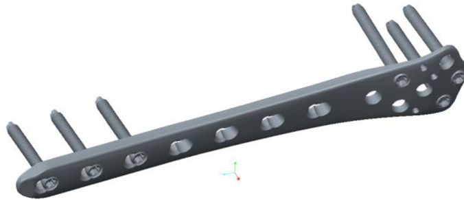
Obrázok 10.10: Geometrická konfigurácia s označením X6, využité otvory pre skrutky D, E, G, a 5,6,7( legenda označenia otvorov viď orb.6.17)
