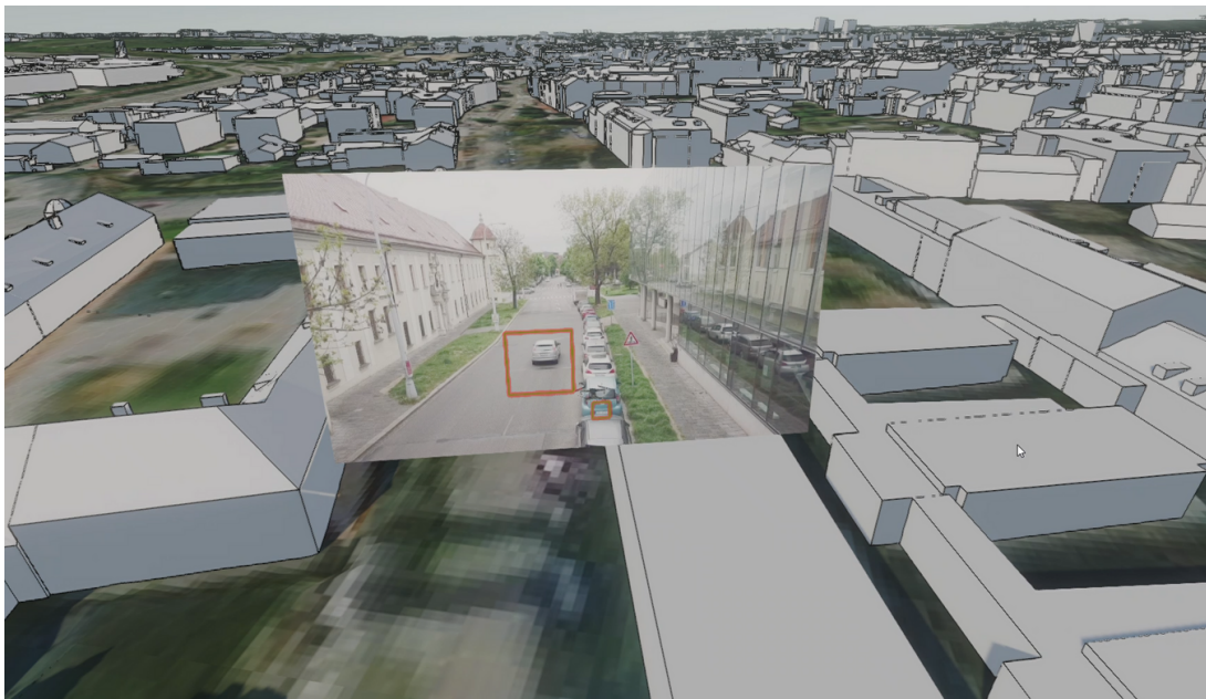
Obrázek 7.1: Aplikace DroCo s obrazem od dronu včetně vykreslených obdélníků detekce vozidel.
