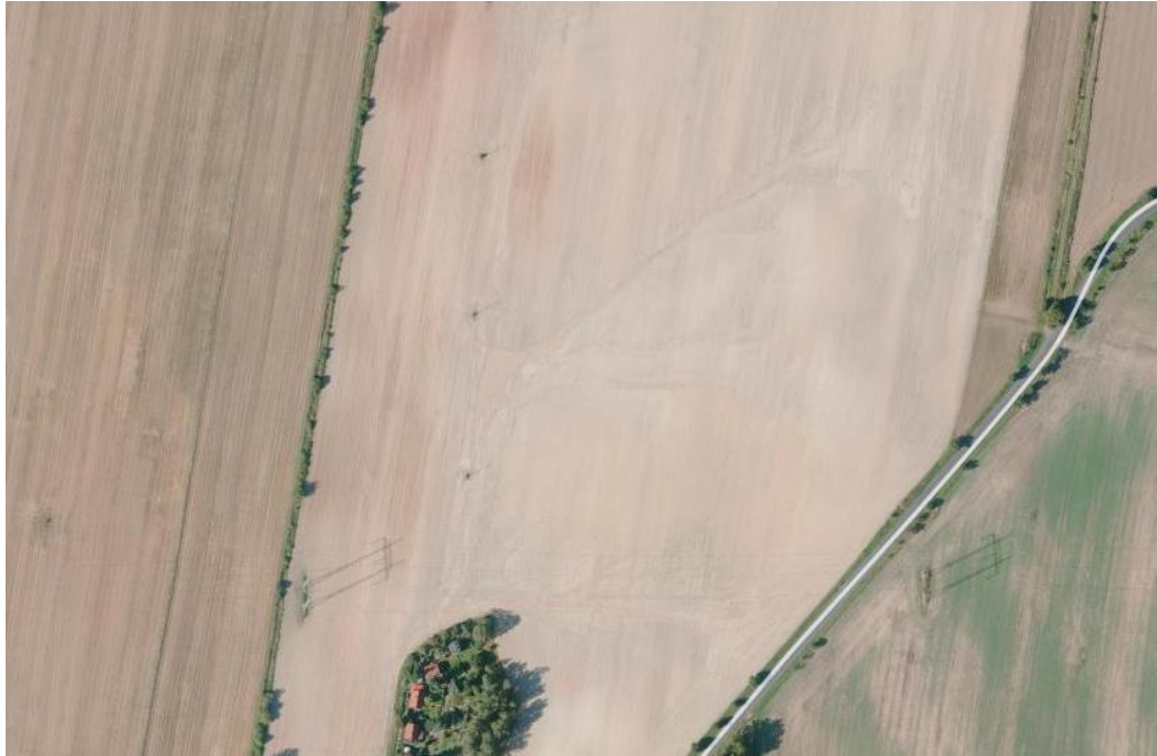
Obrázek 26: Dobře patrné projevy eroze: erozní rýhy, dráhy soustředěného odtoku a zóny sedimentace splavenin v lokalitě u Buckého rybníka (mapy.cz, 2020)
