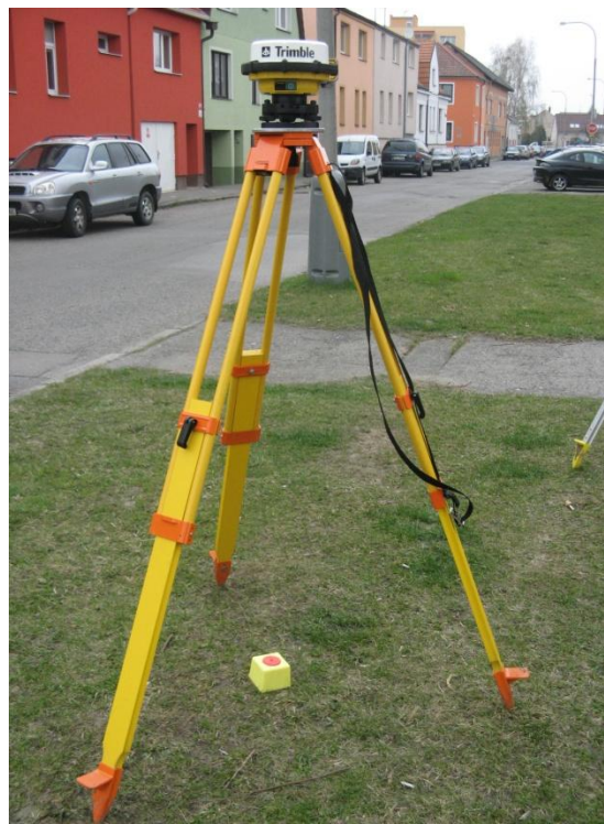
foto. 5.: GPS aparatura Trimble 4600 LS – vlastní zdroj
