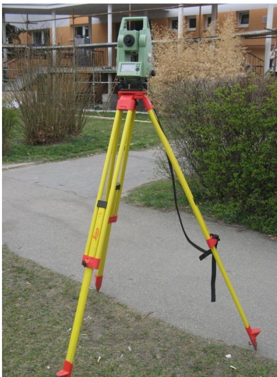
foto. 4.: Totální stanice Leica TCR 407 power – vlastní zdroj
