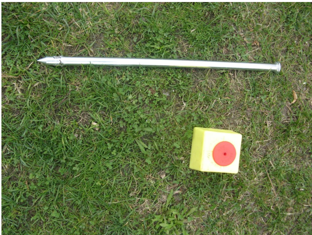
foto. 2.: Plastový mezník a ocelová trubka – vlastní zdroj
