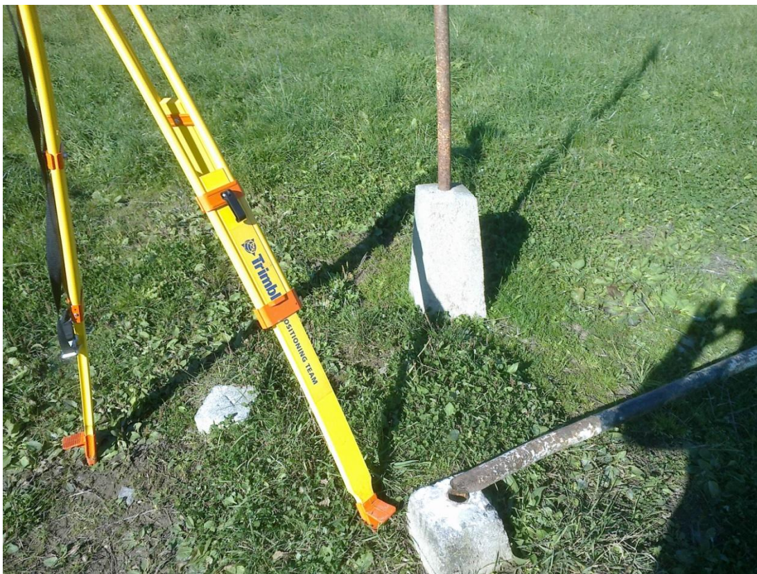
foto. 1.: Zlomená ochranná tyč na bodě číslo 210 - vlastní zdroj
