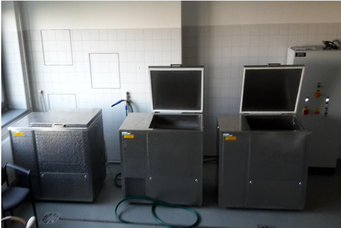
Obr. 4 Mikrosladovna Mendelovy univerzity – skříně pro máčení, klíčení a hvozdění (foto autor)
