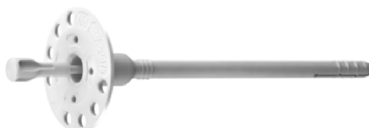
Obrázek 30: Talířová hmoždinka se zatloukáčím umělohmotným trnem [84]
