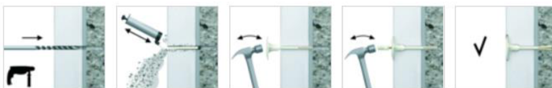
Obrázek 31: Postup montáže hmoždinky se zatlučovací trnem [84]
