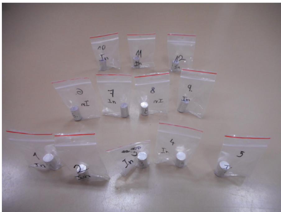
Obr. 2.8: Zabalené vzorky india připravené k měření v HPGe detektoru.
