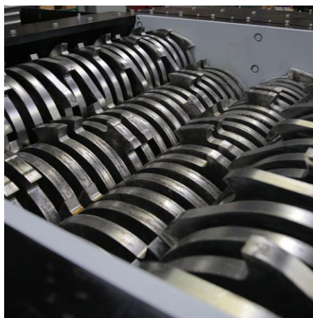
Obr. 2-7 Pracovní prostor čtyřhřídelového drtiče [7]
