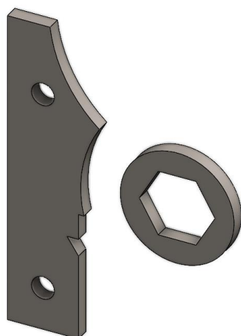
Obr. 2-18 Vložky – vlevo: mezi stacionární nože, vpravo: mezi rotující nože
