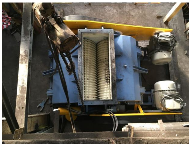
Obr. 2-9 Pohled na pracovní prostor válcového drtiče při instalaci [8]
