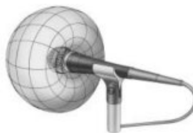
Obrázek 5 Směrový diagram a náčrt mikrofonu s kardioidní charakteristikou, zdroj: [35]
