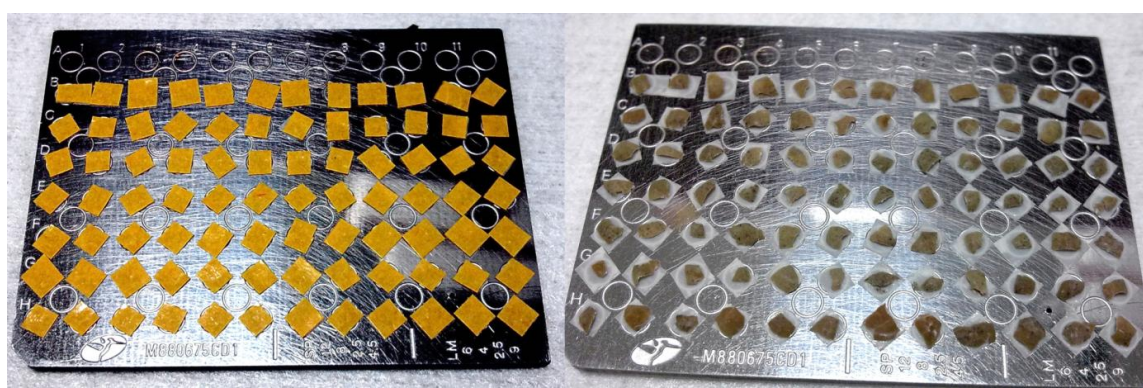
Obrázok 17: Príprava MALDI doštičky ( A – prvá fáza prípravy s obojstrannou lepiacou páskou, B – MALDI plate s prichytenými časťami osemenia)
