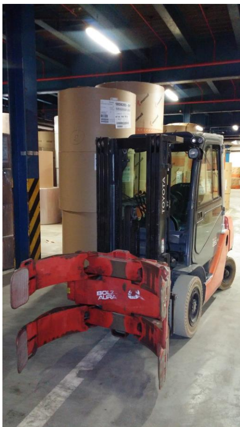
Obr. č. 13. Ukázka chapadlového nástavce a papírové role [15]
