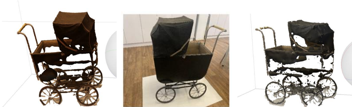
Obrázek 24 - Vlevo 3D model vzniklý ze snímků pořízených digitální zrcadlovkou, uprostřed snímek originálního předmětu, vpravo snímek modelu vzniklý z fotografií pořízených chytrým telefonem.
