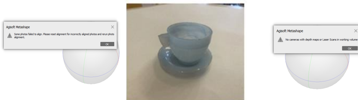
Obrázek 30 – Vlevo chyba zobrazená při vytváření modelu ze snímků pořízených digitální zrcadlovkou, uprostřed snímek originálního předmětu, vpravo chyba zobrazená při vytváření modelu ze snímků pořízených chytrým telefonem.
