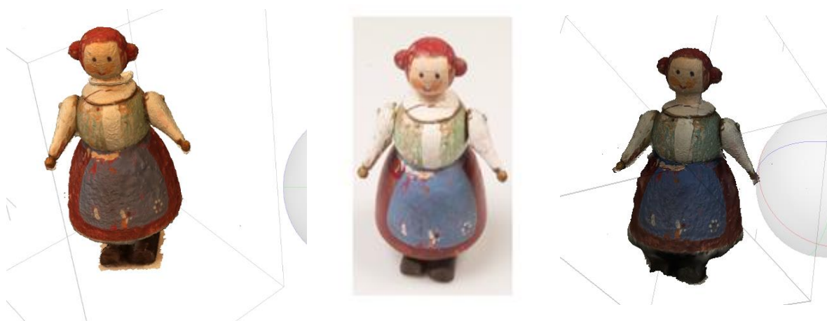
Obrázek 15 - Vlevo 3D model panenky vzniklý ze snímků pořízených digitální zrcadlovkou, uprostřed snímek originálního předmětu, vpravo snímek modelu vzniklý z fotografií pořízených chytrým telefonem.
