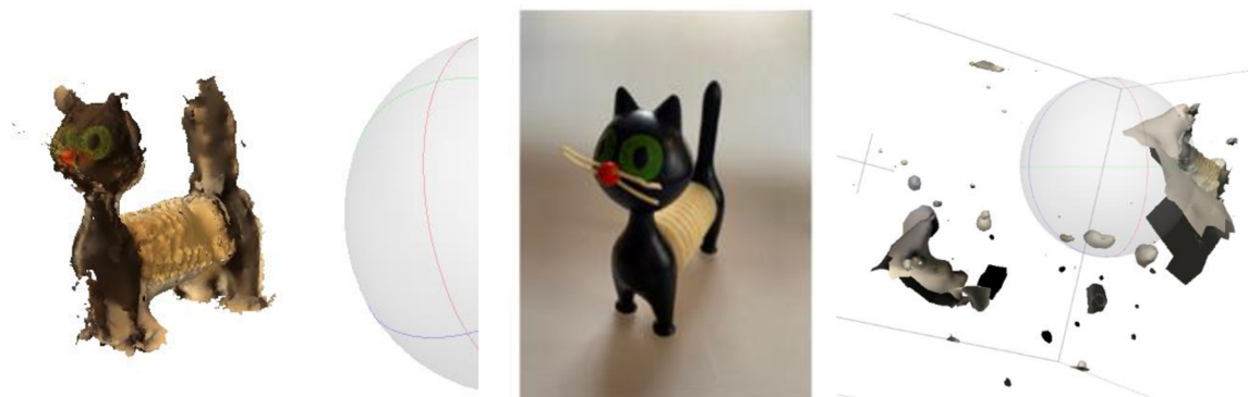
Obrázek 26 - Vlevo 3D model vzniklý ze snímků pořízených digitální zrcadlovkou, uprostřed snímek originálního předmětu, vpravo snímek modelu vzniklý z fotografií pořízených chytrým telefonem.
