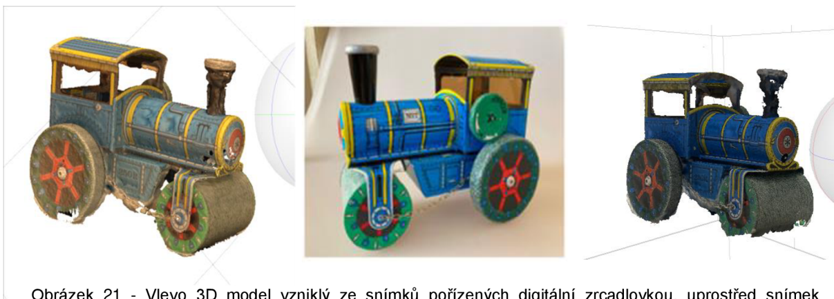
Obrázek 21 - Vlevo 3D model vzniklý ze snímků pořízených digitální zrcadlovkou, uprostřed snímek originálního předmětu, vpravo snímek modelu vzniklý z fotografií pořízených chytrým telefonem.
