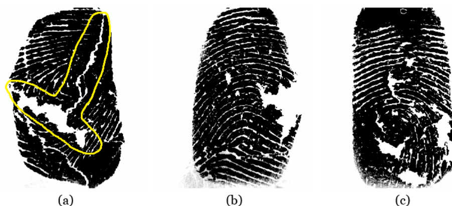
Obrázok 5.5: Obrázky falzifikátov odtlačkov prstov vyrobených z materiálu Cernit po snímaní skenerom. Obrázky pochádzajú z databázy výskumnej skupiny STRaDe.
