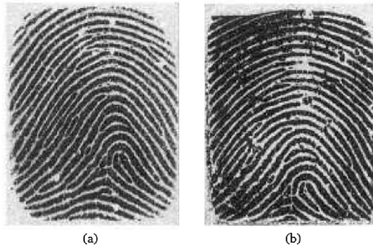
Obrázok 3.1: Gumené umelé prsty: (a) odtlačok prsta, ktorý bol použitý ako vzor pri výrobe formy z jedlého želé, (b) obrázok získaný z kapacitného senzoru po nasnímaní formy pritlačenej na povrch senzora živým prstom. Obrázok bol prebraný a modifikovaný z [31].
