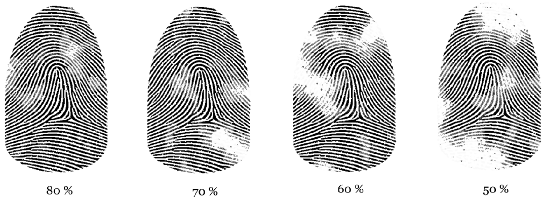
Obrázok 6.7: Náhodné generovanie oblastí s nižšou jasnosťou s rôzne zvoleným pomerom medzi plochou oblastí s hrubšou vrstvou materiálu a celkovou plochou odtlačku prsta.
