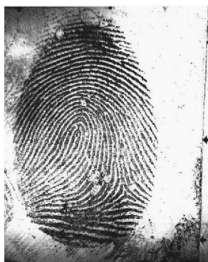
Obrázok 3.5: Falzifikát odtlačku prsta vyrobený prenosením stopy odtlačku prsta pomocou lepidla a detegovaný hliníkovým práškom. Obrázok bol prebraný a modifikovaný z [26].
