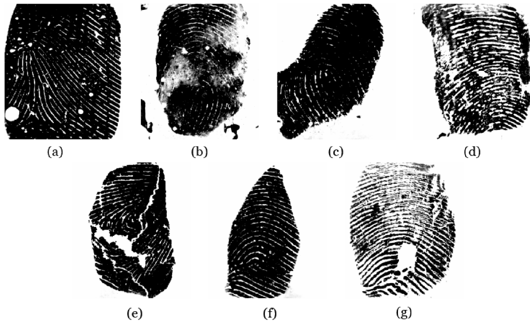
Obrázok 3.6: Artefakty falzifikátov odtlačkov prstov: (a) vzduchové bubliny, (b) oblasti papilárnych líní s nižšou jasnosťou, (c) nerovnomerné šírky papilárnych líní a medzier medzi nimi, (d) skreslené papilárne línie, (e) defekt v materiáli, (f) neprirodzený celkový tvar, (g) oblasť s chýbajúcimi papilárnymi líniami. V niektorých obrázkoch falzifikátov je prítomných viac artefaktov, v opise je uvedený vždy len jeden artefakt, pre ktorý bol falzifikát vybraný ako reprezentujúci zástupca. Obrázky falzifikátov pochádzajú z databázy výskumnej skupiny STRaDe 1 [38], ktorá pôsobí na Fakulte informačných technológií Vysokého učení technického v Brne.
