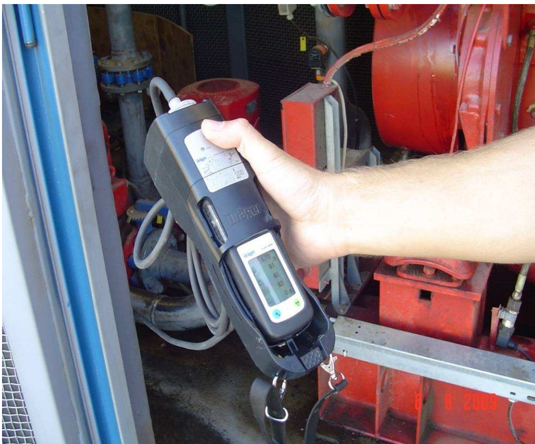
Příloha č. 13: Měření obsahu metanu ( \text{CH}_4 ) ve skládkovém plynu, 8. 9. 2009
