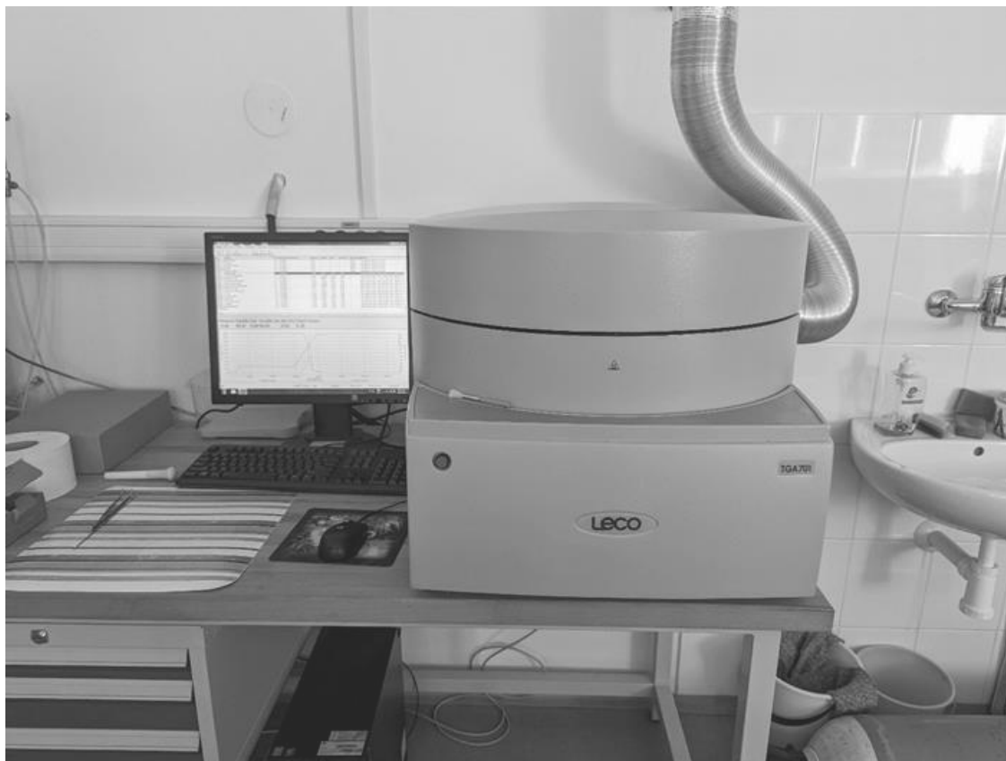
Obrázek 9: Termogravimetrický analyzátor TGA701 (zdroj: vlastní foto)
