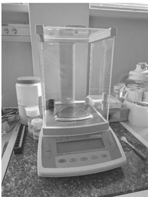
Obrázek 6: Laboratorní váha Sartorius SP124 S (zdroj: vlastní foto)
