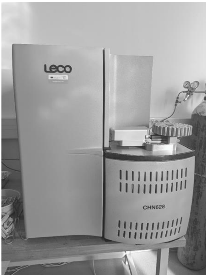
Obrázek 8: Analyzátor CHN628 (zdroj: vlastní foto)
