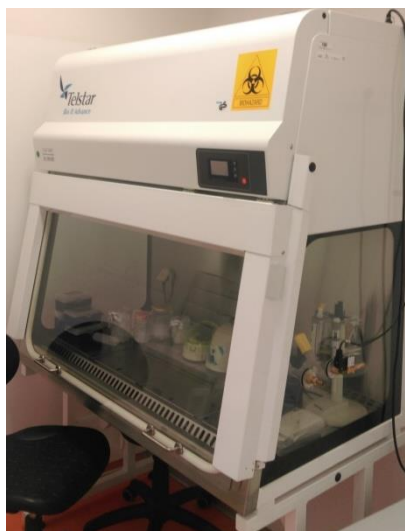
Obrázek 15 - Biohazard box Bio II Advance od společnosti Telstar
