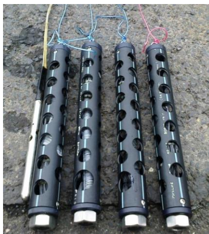
Obrázek 11 - Vzorkovací patrony s nanovlákněnými nosiči biomasy
