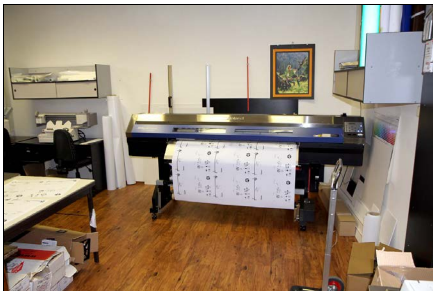
Obr. 5: Pracoviště velkoplošného digitálního tisku pracujícího na bázi eko-solventních inkoustových náplní kombinované s řezacím plotrem
