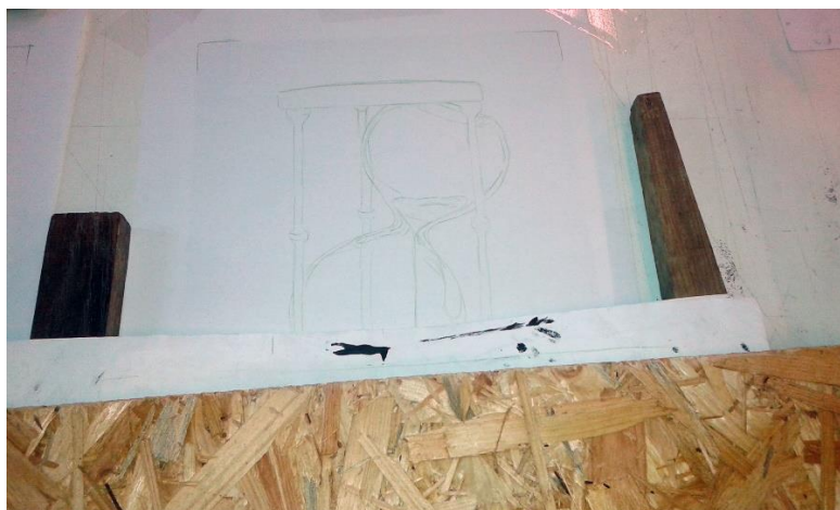
43/ Nákres položený na matrici zajištěný izolepou a oslí můstek
