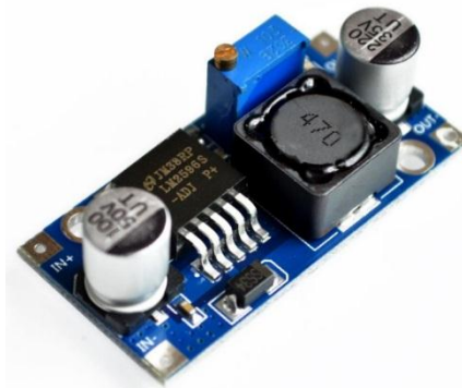
Obrázek 26 Stepdown měnič napětí [14]
