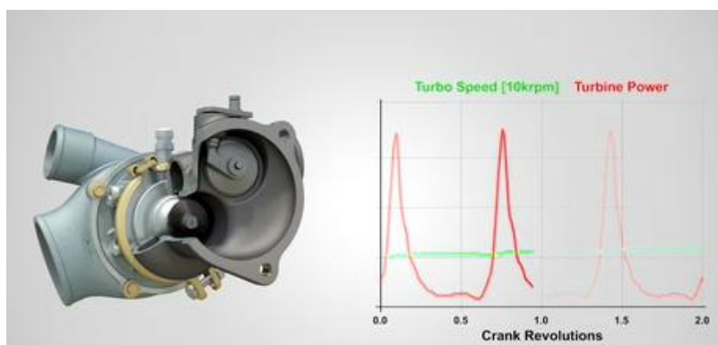
Obr. 14 Průběh rychlosti turbíny (zeleně) a pulzy způsobené cyklem motoru (červeně) [7]
