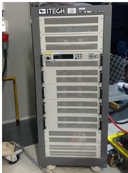
Obrázek 7.2: Jednotka emulátoru vysokonapěťové baterie s DC zdrojem ITECH IT6000C.
