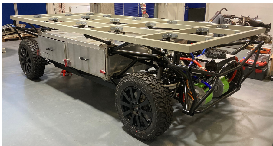
Obrázek 4.1: Autonomní modulární podvozková platforma AnteTUL.
