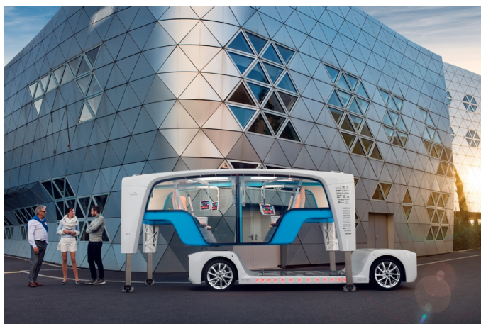
Obrázek 2.6: Podvozková platforma Snap s automaticky oddělitelnou nástavbou od firmy Rinspeed. [49]
