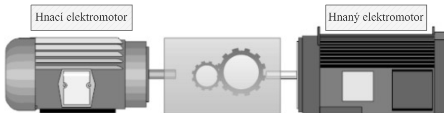
Obrázek 2.9: Princip metody „Back-to back-electrical“. [16]
