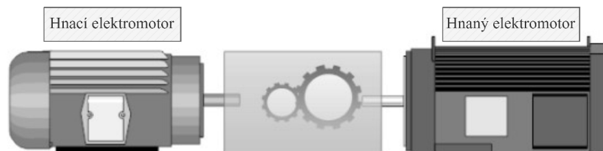
Obrázek 2.9: Princip metody „Back-to back-electrical“. [16]
