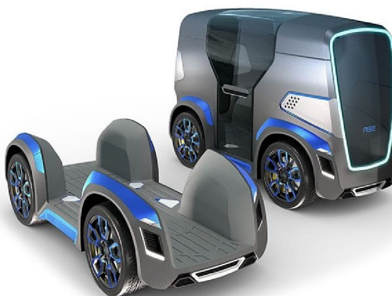
Obrázek 2.5: Podvozková platforma s pevnou nástavbou od firmy REE. [43]
