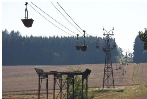
Obr. 11: Nákladní lanovka dopravující kusový vápenec z Černého Dolu do závodu v Kunčicích nad Labem
