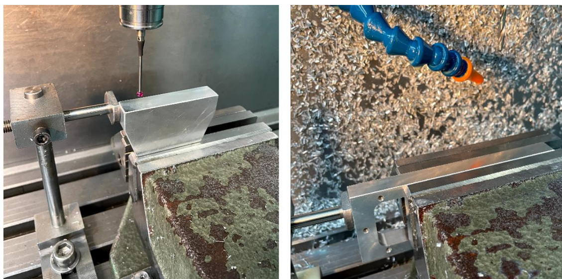
Obr. 54 Systém dorazu a obrábění neprogramovaných prvků.
