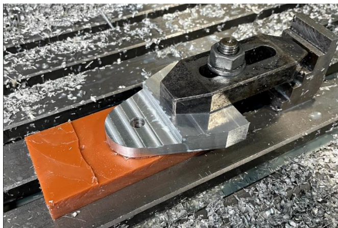
Obr. 55 Způsob upnutí obrobku pomocí upínky a plastové podložky
