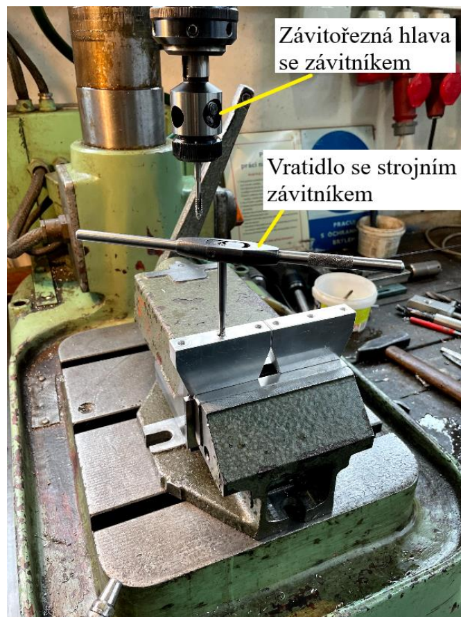
Obr. 56 Řezání závitů.
