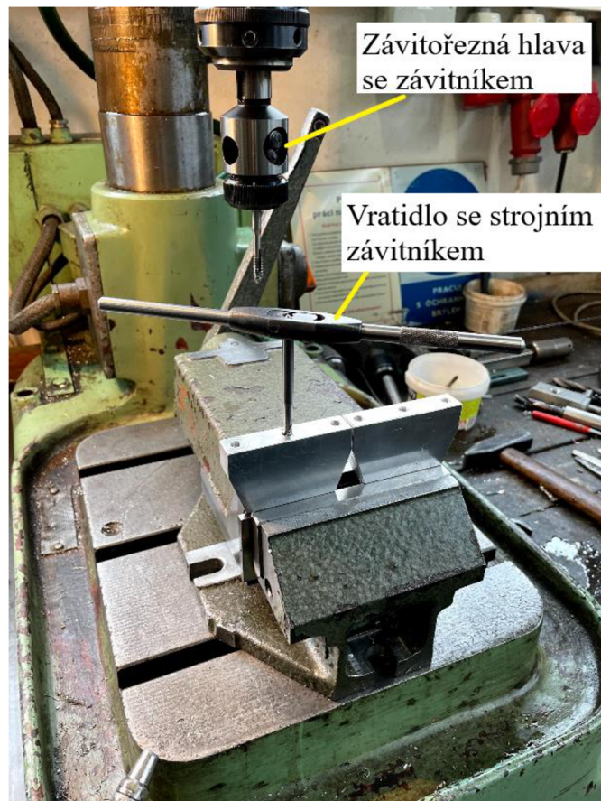
Obr. 56 Řezání závitů.
