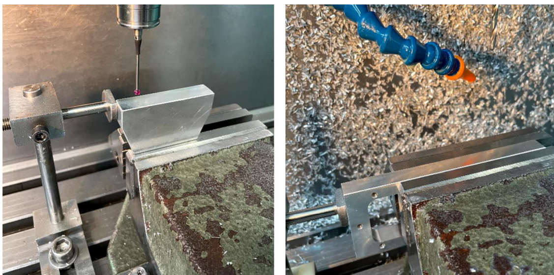
Obr. 54 Systém dorazu a obrábění neprogramovaných prvků.
