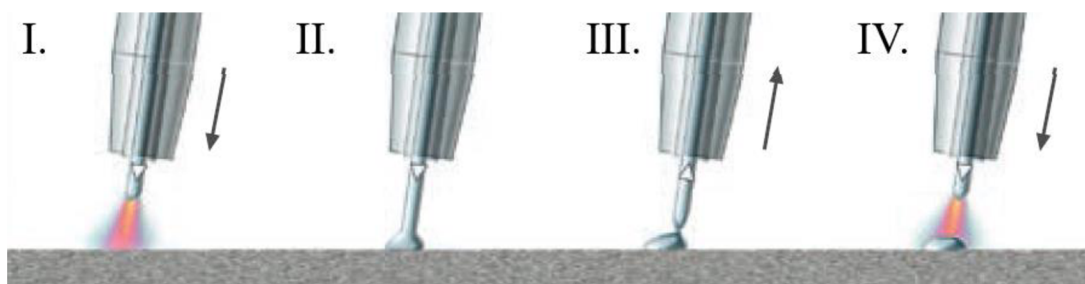
Obr. 14 Fáze CMT cyklu: I. Fáze hoření oblouku–materiál veden do lázně. II. Fáze ponoření drátu do tavné lázně–oblouk zhasne, svařovací proud poklesne. III. Zpětný pohyb drátu–uvolnění kapky během zkratu, udržení nízkého proudu po přerušení zkrat. obvodu. IV. Změna směru pohybu drátu a opětovné spuštění procesu. [40]
